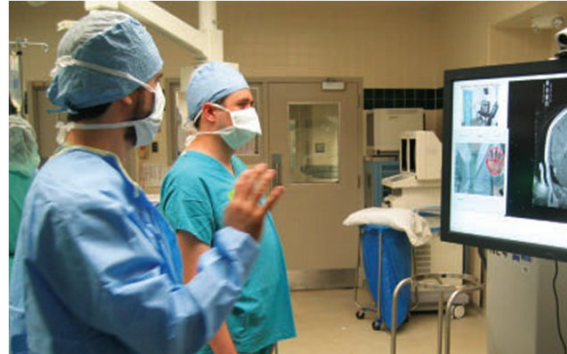
Abbildung 2.5: Das Gestix System dient zur sterilen Navigation und Manipulation von Bildern im Operationssaal [25]
