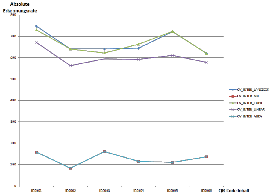
Abbildung 4.2.1: Vergleich der Verfahren zur Interpolation, bei einer Auflösung von 1280 x 1024 und einer QR-Code Größe von 2,3 cm in einem aufgenommenen Referenzvideo. Aufgetragen sind die Inhalte sowie die Anzahl der erkannten QR-Codes für jede Interpolation.
