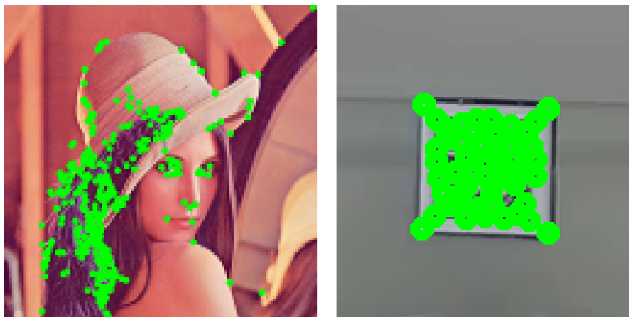
Abbildung 2.1.1: Veranschaulichung des Good Features to Track Algorithmus am Beispiel von Lena (links) und an einem QR-Code (rechts). Die Stellen, die in der Abbildung grün eingezeichnet sind, spiegeln die errechneten GFTT-Keypoints wieder.
